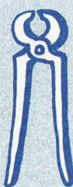
NAGELRAUSZIEHZANGE RUNDER KOPF ZUM ABROLLEN BEIM HERAUSZIEHEN VON NÄGELN.
